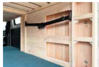
リヤ右側キャビネットのオープンラック
